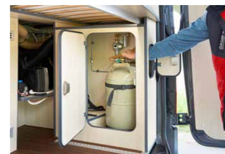
Gaskasten mit kleiner Luke für den einfachen Zugriff auf die Ventile der 11-kg-Flaschen.
