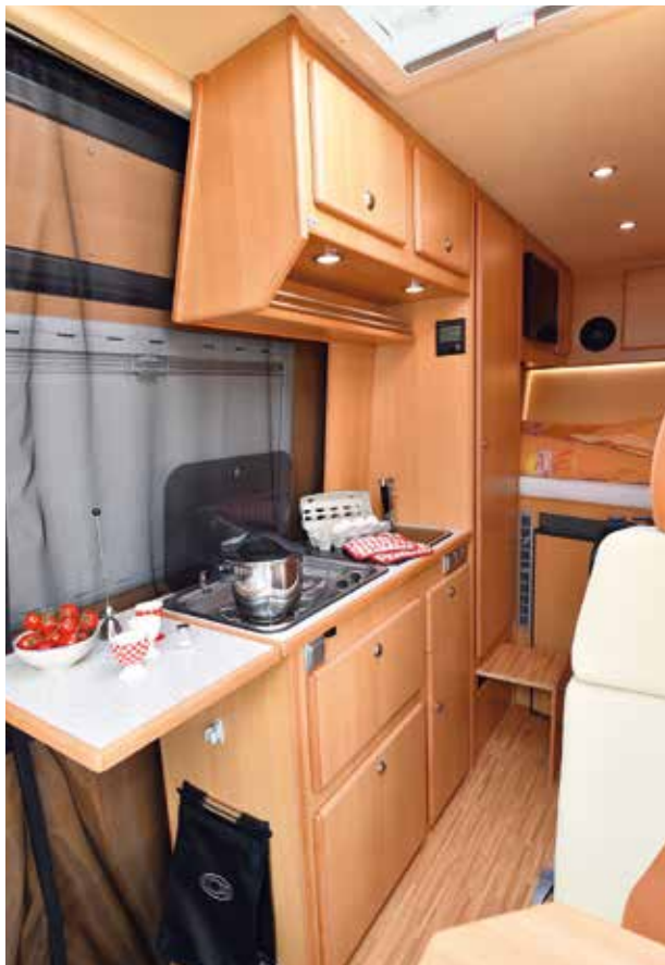
Die ausklappbare Arbeitsfläche der Küche ist auf gleicher Höhe mit der Arbeitsplatte. Der Kühlschrank sitzt unter dem Bett.
