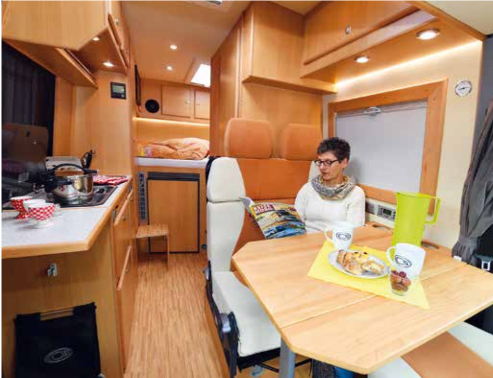
Ausgeklappt ist der stabile Massivholz-Tisch 110 Zentimeter breit. Mit wenigen Handgriffen lässt er sich, etwa zur Fahrt, auf 80 Zentimeter zusammenklappen.
