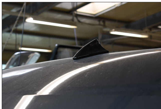
Alphasystems LTE Antenne mit WLAN-Router
