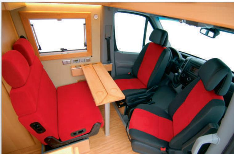
Die Tischanlage ist verschiebbar, dadurch ergeben sich flexible Möglichkeiten der Nutzung für die Sitzgruppe. An der Tischaufnahme findet sich ein pfiffig konstruierter Flaschenhalter, der das Abstellen von Flaschen bzw. Gläsern (auch bei nicht aufgebautem Tisch) ermöglicht. Unterhalb dieser Ablage ist ein Zeitungsfach in die Seitenverkleidung integriert.
