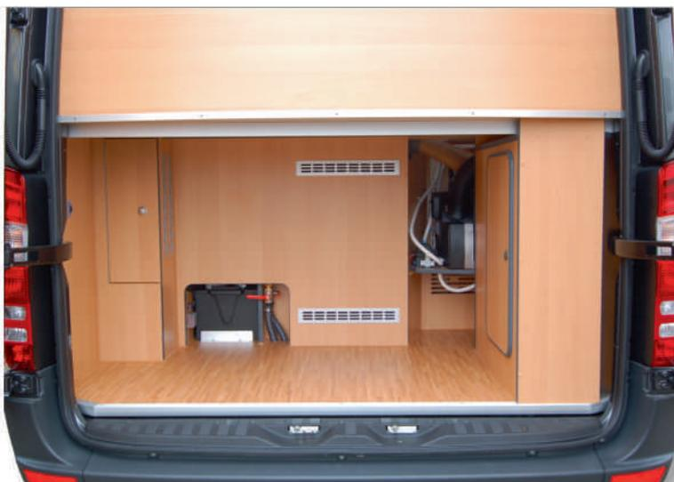
Als Wunschkomponenten stehen für die Gestaltung u.a. Parkettfußboden, eine Fußbodenheizung oder eine automatische, digitale Satellitenanlage zur Verfügung. Der Frischwassertank fasst 100 Liter, der Abwassertank hat eine Kapazität von 85 Liter und ist unterflur untergebracht (ein weiterer Abwassertank kann zusätzlich frostsicher im Heckstauraum montiert werden).
