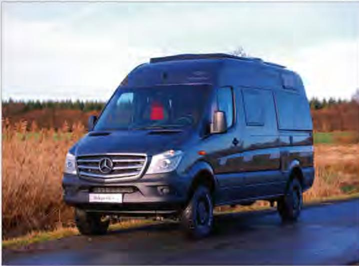
Unser Modell Independent basiert auf dem Mercedes Sprinter mit einem Radstand von 3.665 mm. Daraus ergibt sich eine Außenlänge des Fahrzeugs von 5,91 m.
