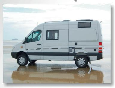
Unser Modell Independent basiert auf dem Mercedes Sprinter mit einem Radstand von 3.665 mm. Daraus ergibt sich eine Außenlänge des Fahrzeugs von 5,91 m.
