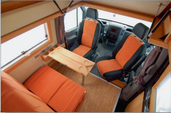
Unser Modell Corona basiert auf dem Mercedes-Benz Sprinter mit dem Radstand 3.665 mm. Daraus ergibt sich eine Außenlänge des Fahrzeuges von 5,91 m und eine Breite von 1,99 m.
