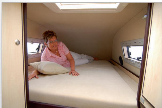
Neben dem Sanitärkomfort haben wir ein besonderes Augenmerk auf den Schlafkomfort gelegt. Im Dach des Corona befindet sich ein Hubbett mit Gelenk zur optimalen Anpassung an die Dachkontur. Das Bett ist hinterlüftet und mit einer federnden Konstruktion ausgestattet. Die Abmessungen betragen ca. 210 cm x 150 cm. Die lichte Höhe oberhalb der Matratze beträgt ca. 70 cm.
